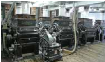
年代物の製粉機が10台近く並ぶ。一日20t製造。店では一日400kg使用する
